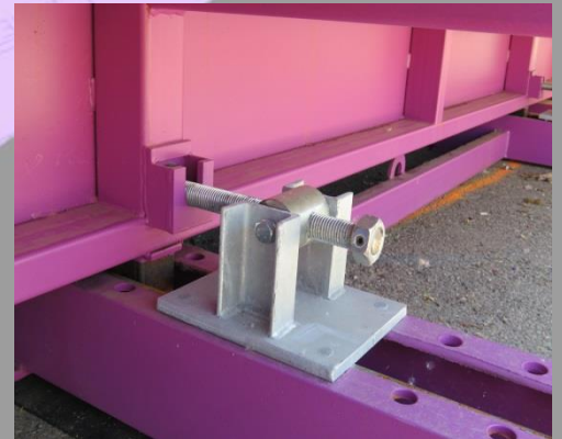
Système de serrage bas amovible
