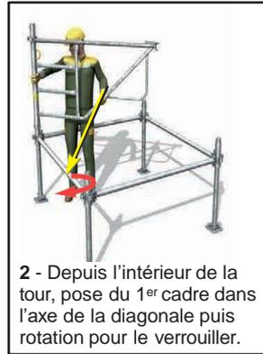
2 - Depuis l'intérieur de la tour, pose du 1<sup>er</sup> cadre dans l'axe de la diagonale puis rotation pour le verrouiller.
