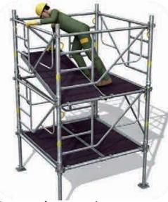
6 - accès au niveau supérieur puis pose du 2<sup>e</sup> plancher à trappe.
