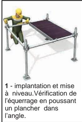
1 - implantation et mise à niveau. Vérification de l'équerrage en poussant un plancher dans l'angle.
