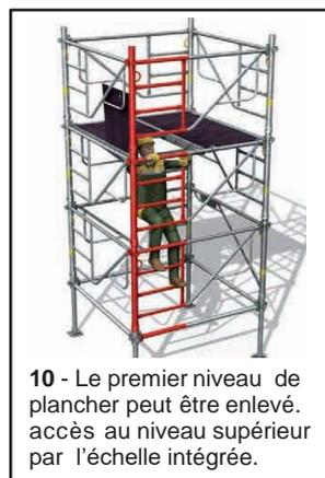
10 - Le premier niveau de plancher peut être enlevé. accès au niveau supérieur par l'échelle intégrée.
