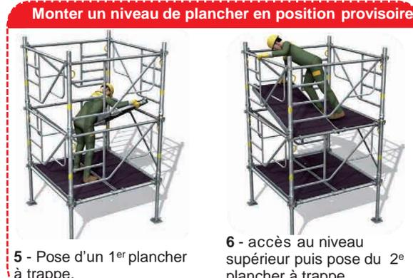
5 - Pose d'un 1<sup>er</sup> plancher à trappe.
