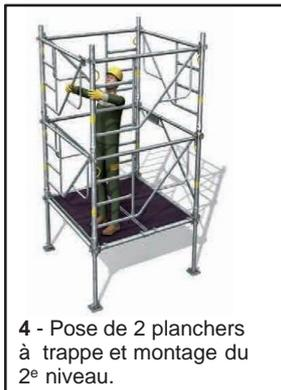
4 - Pose de 2 planchers à trappe et montage du 2<sup>e</sup> niveau.
