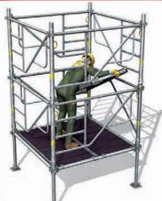
5 - Pose d'un 1<sup>er</sup> plancher à trappe.
