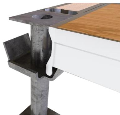
La console permet la mise en place de porte-à-faux et facilite la sécurité
