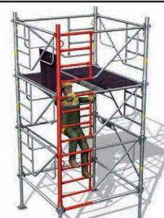
10 - Le premier niveau de plancher peut être enlevé. accès au niveau supérieur par l'échelle intégrée.
