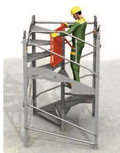
Pose ou dépose du garde-corps de fermeture.
