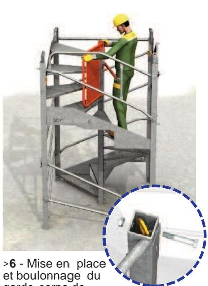
>6 - Mise en place et boulonnage du garde-corps de fermeture : la lisse de montage est en position horizontale.
