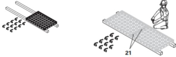
2. Déposer deux panneaux avec la peau coffrante orientée vers le sol et les assembler à l'aide du connecteur DUO au niveau de la jonction courte.
